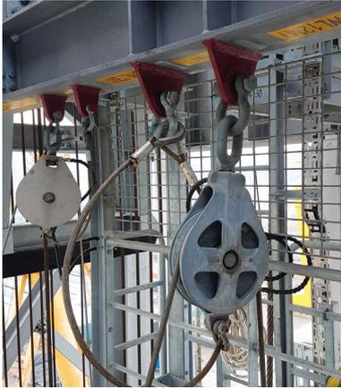
圖12：裝有安全固定裝置的開口滑輪
