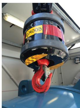
圖16：起重吊鉤應始終配備安全裝置，以防負載脫鉤
