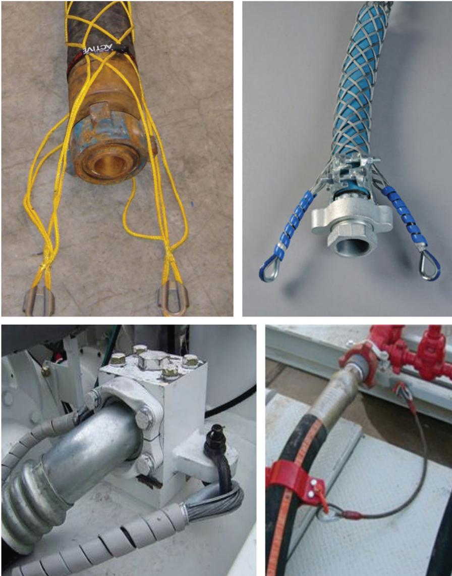
圖17：懸吊軟管和輔助環路管線存在安全問題（來源：DROPS）
